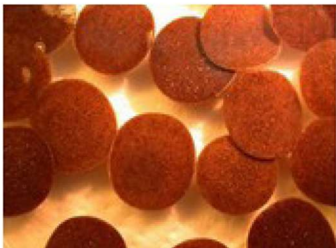
Рис. 1 и 2: Высокоэффективный носитель Mutag BioChip для биопленок – неокрашенный, без биопленки (белый) и окрашенный, без биопленки (оранжевый).
